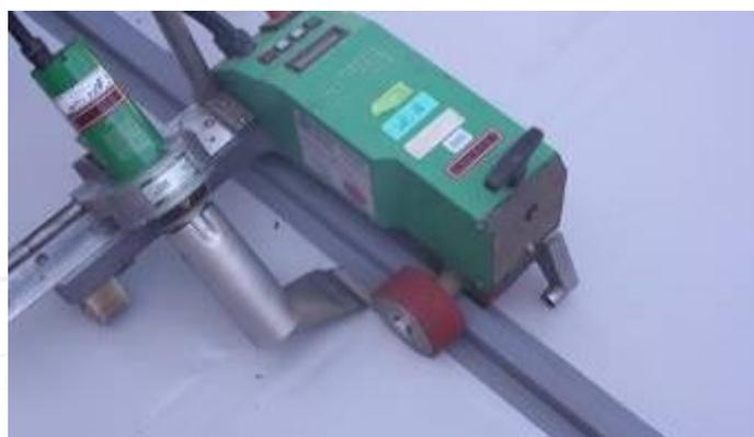
**Fig. 5 – Soudure du profilé PVC avec un robot équipé du kit de soudure RENOLIT ALKORSOLAR 81078**
