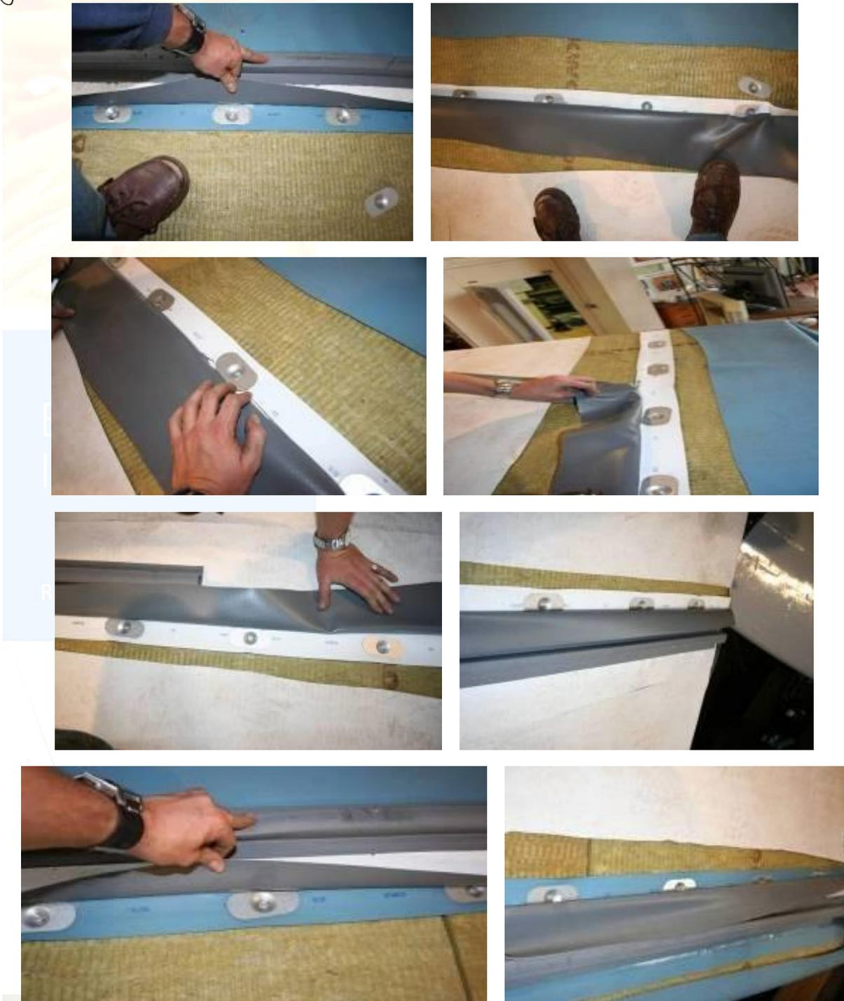
**Fig. 38** – Toutes ces photos ont été prises lors du démontage des maquettes (membrane coupée). Elles démontrent clairement que les fixations mécaniques et plaquettes étaient intactes après les essais
